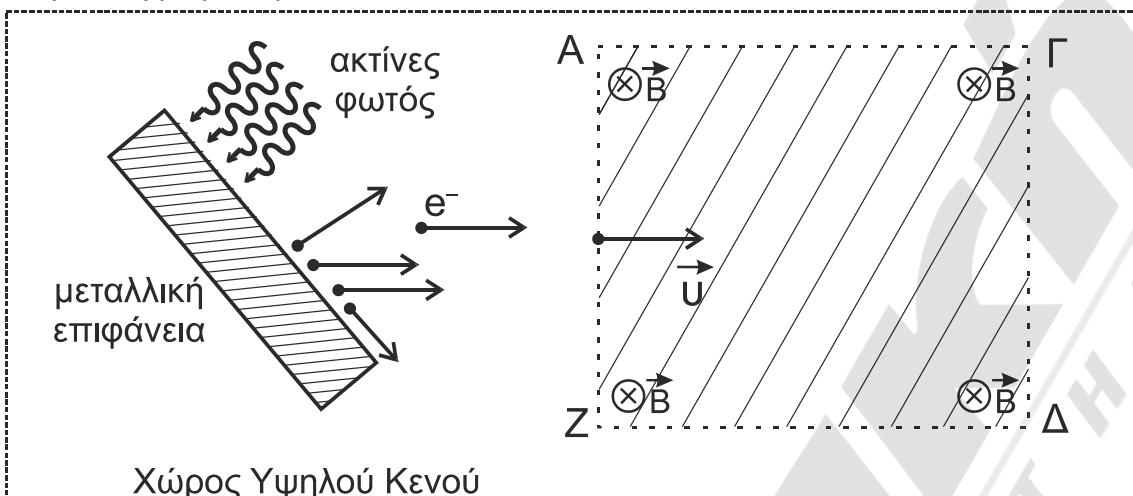
Γνωρίζουμε ότι το Βάριο έχει έργο εξαγωγής  $2,5 \text{ eV}$ , το Βολφράμιο  $4,5 \text{ eV}$  και το Ταντάλιο  $4,2 \text{ eV}$ . Σε ένα εργαστήριο πραγματοποιούμε δύο πειράματα για να προσδιορίσουμε το υλικό κατασκευής της μεταλλικής επιφάνειας.
