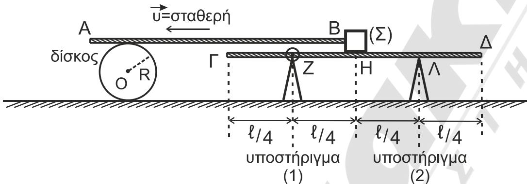
Το σύστημα ράβδου-σώματος  $\Sigma$  κινείται προς τα αριστερά με σταθερή ταχύτητα μέτρου  $u$ . Ο δίσκος εκτελεί κύλιση χωρίς ολίσθηση και η περιφέρεια του βρίσκεται σε συνεχή επαφή με τη ράβδο  $AB$ , χωρίς να παρατηρείται ολίσθηση μεταξύ τους.
